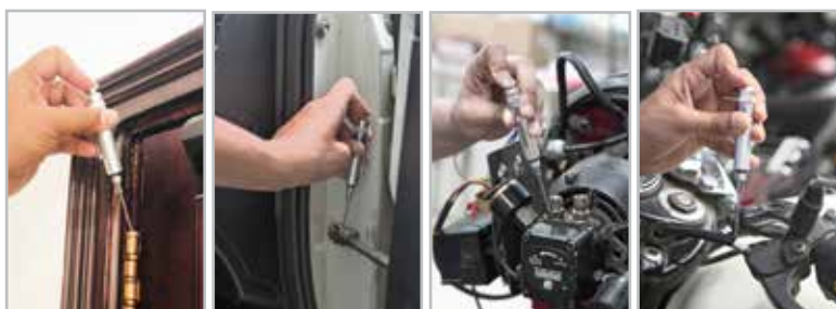
Игольчатая насадка обеспечивает точечную заправку в труднодоступных местах
