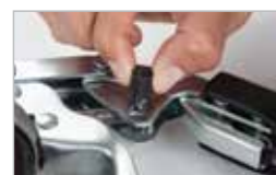
Рычаг для переключения высокое давление /большой объем смазки
