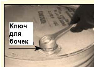
2. Извлеките переходник из всасывающей трубки и вкрутите его в 5 см отверстие бочки.
