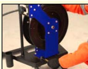
2. Присоедините пистолет с цифровым счетчиком к выходному отверстию барабана для шланга.
