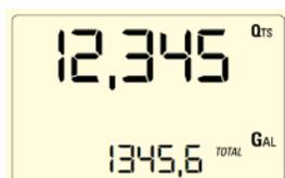
3. Нажмите кнопку RESET (сброс) коротким нажатием. Счетчик сбросит значение объема порции.
