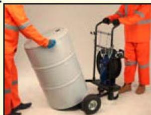
2. Приподнимите бочку с другой стороны и задвиньте ее на опорную раму до упора в пластину основания.
