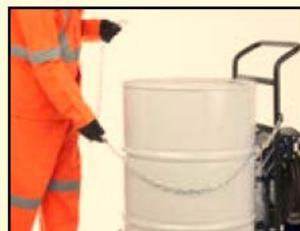
4. Заблокируйте оба задних колесика (4), нажав ногой на фиксатор.
