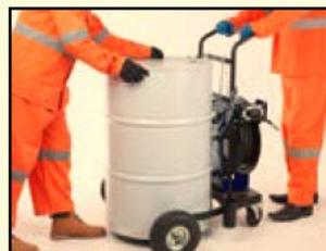
3. Установите и закрепите бочку к тележке с помощью металлической цепи.
