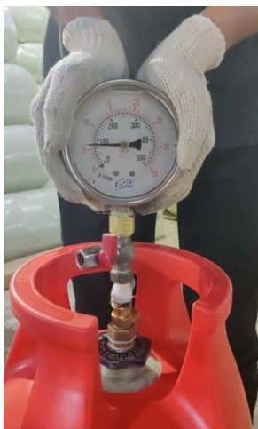
Испытание под давлением
