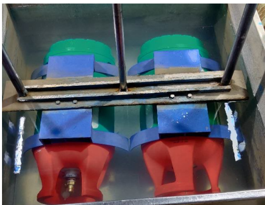
Проверка на наличие пузырьков при погружении в воду
